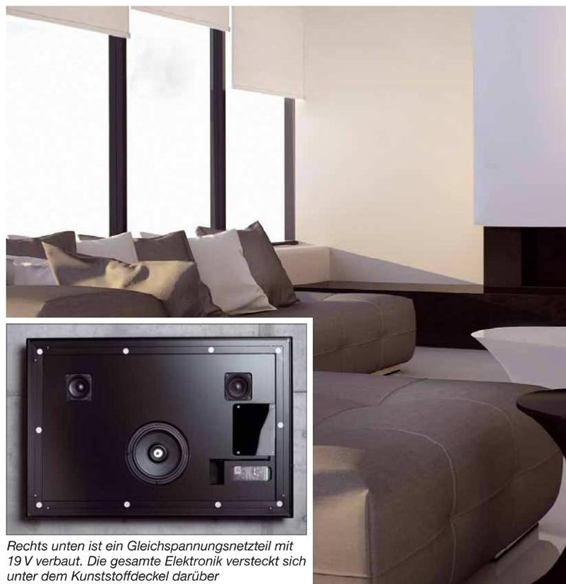
Rechts unten ist ein Gleichspannungsnetzteil mit 19 V verbaut. Die gesamte Elektronik versteckt sich unter dem Kunststoffdeckel darüber
