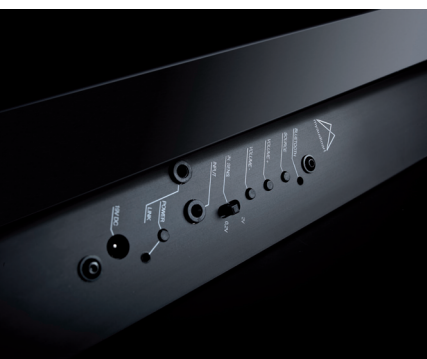
Über den Link-Anschluss kann man zwei MA3 im Verbund als leistungsstarkes Stereosystem betreiben.
