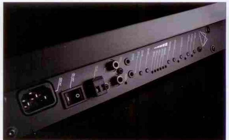
Versteckt an der rechten Seite des Bilderrahmens sind die Anschlüsse und die Bedienelemente zugänglich. Diverse LEDs informieren über Status und verbundene Zuspieler
